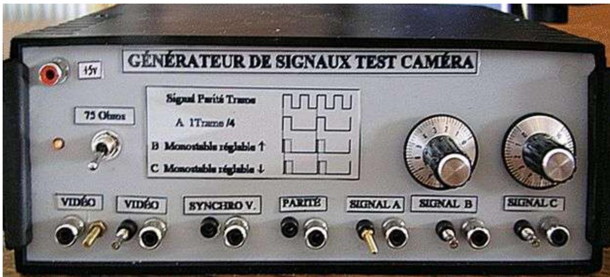
Les deux boutons servent à régler les largeurs des signaux B et C.
