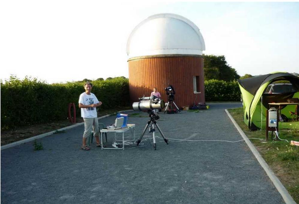
Le tube est monté sur une monture CELESTRON CG5 approximativement mise en station au viseur polaire (Jacques lui fait du Bigourdan – c'est pour cela qu'il y a une tente sur la droite : il se repose pendant les dérives).
