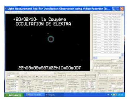
On a fait l'acquisition de la vidéo avec VirtualDubMod, les mesures avec le logiciel Limovie et le graphe avec un tableur en utilisant les mesures faites par Limovie.
