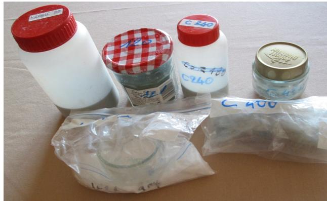
Les dalles de verre démoulées vont être rodées l'une contre l'autre avec interposition d'**abrasifs**, c'est à dire d'un matériau pulvérulent, plus dur que le verre, et d'eau. En effet, il faut toujours utiliser les abrasifs en milieu aqueux, sous peine de voir la température des surfaces de s'élever de façon importante. L'expérience de friction de deux morceaux de pierre ou de bois a permis à l'homme préhistorique de découvrir un moyen de faire du feu !
