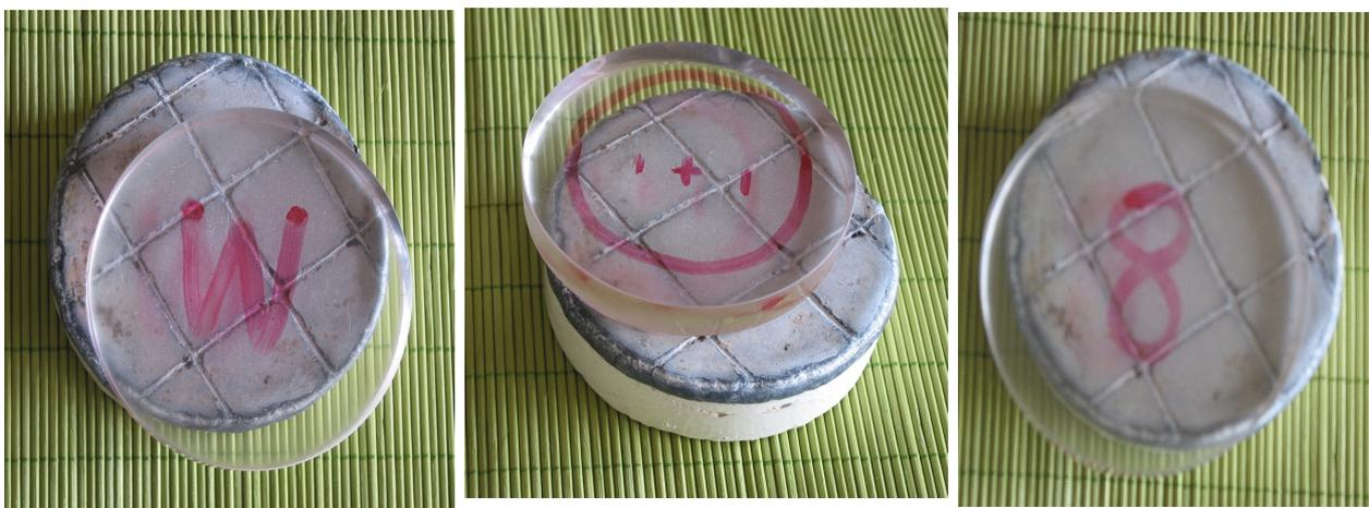
L'abrasif évolue au cours du travail. Pour la démonstration, il est plus aisé de montrer un gros grain. Vous voyez successivement l'abrasif sec puis humide en début de séchée, puis la purée d'abrasif et de verre à la fin de la même séchée.
