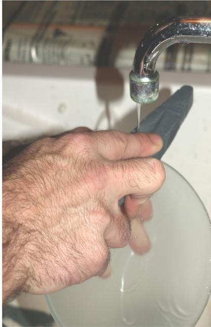
Nous installons O sur le poste fixe, déposons de l'abrasif en saupoudrant et humidifions avec un pulvérisateur (récupération de flacon de produit ménager soigneusement rincé malgré tout !). M vient se placer sur O, avec précaution, c'est quand même du verre ! Et la première séchée d'ébauchage commence.
